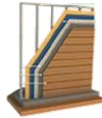
Light Steel Frame (com lâ de vidro)
